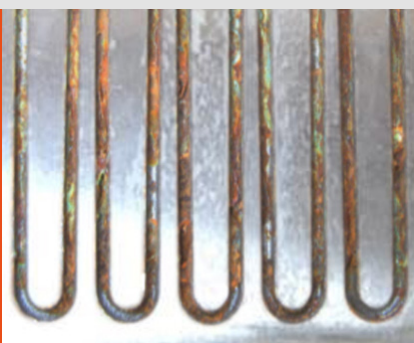
Canais não revestidos, após um ensaio de névoa salina, com duração de 230 horas (solução de NaCl conf. DIN EN ISO 9227) com forte corrosão.
