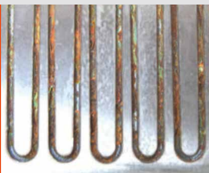
unbeschichtete Kanäle nach 230 Stunden Salzsprühnebeltest (NaCl-Lösung gemäß DIN EN ISO 9227) mit massiver Korrosion
