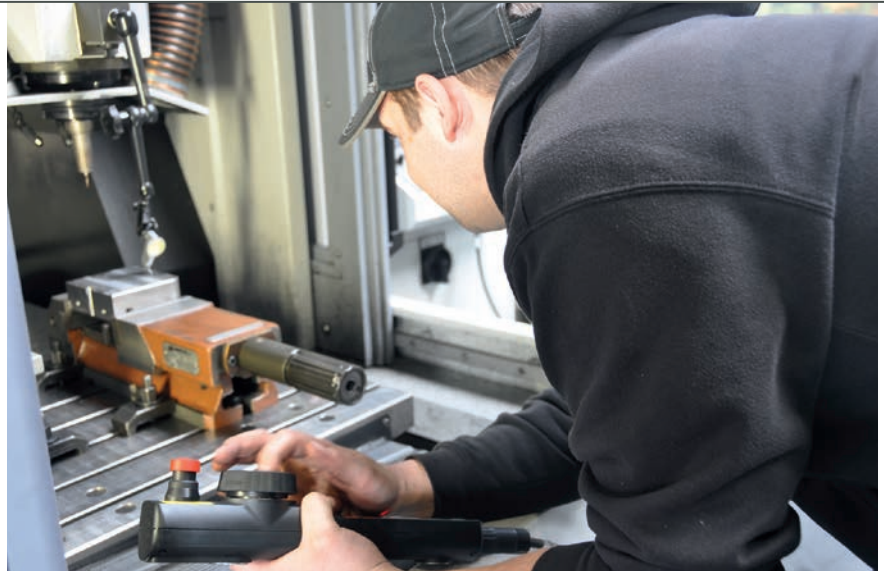
Interner Werkzeugbau: Zehn Mitarbeiter fertigen neue Werkzeuge oder reparieren und warten Bestandswerkzeuge der Kunden. (Bild: Gogoll)
