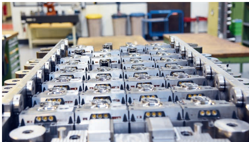
Multikavitäten: Foboha hat sich unter anderem auf Spritzgießwerkzeuge für Flaschenverschlüsse mit bis zu 128 Formnestern spezialisiert. (© Volker Gogoll)
