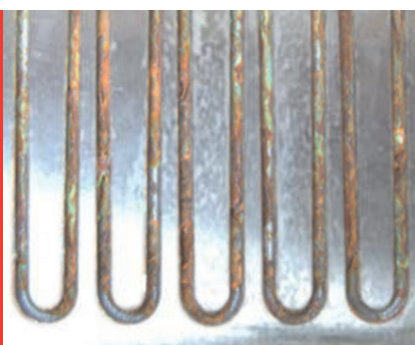
Canais não revestidos, após um ensaio de névoa salina, com duração de 230 horas (solução de NaCl de acordo com a norma DIN EN ISO 9227) com forte corrosão
