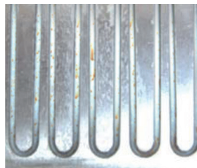
beschichtete Kanäle nach 230 Stunden Salzsprühnebeltest mit minimaler Korrosion
