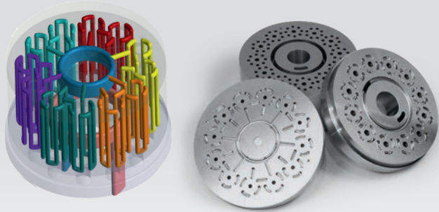
3 Scheiben, 6 Kühlkanäle Ø3 mm, abgehend aus einem gemeinsamen Zu- und Ablauf. Strömungsmechanisch balanciert (identische Strömungsbedingungen in jedem Kanal) dadurch vollkommen homogene Temperierung.
